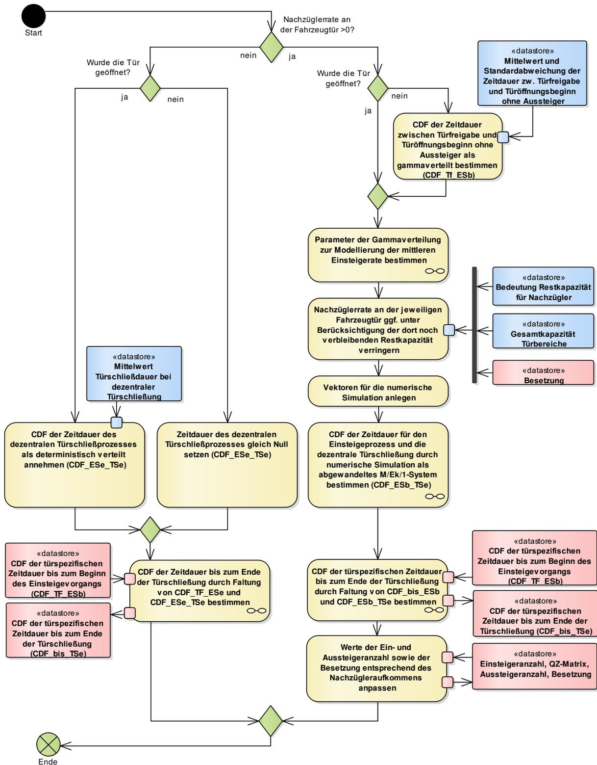
Abbildung 48: Prozessablauf zur Bestimmung der Verteilungsfunktion (CDF) des für die dezentrale Türschließung erforderlichen Zeitbedarfs an einer Fahrzeugtür (Quelle: eigene Darstellung)
