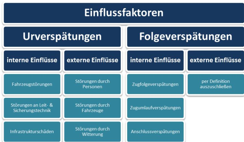
Übersicht der Einflussfaktoren auf den Verspätungsverlauf im Eisenbahnbetrieb
